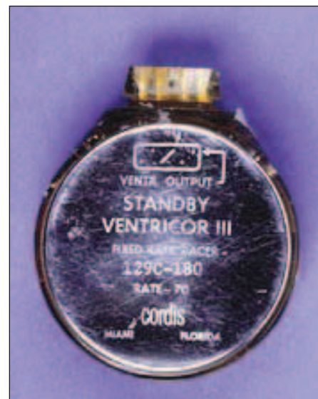
Obr. 4. První „standby“ kardiostimulátor firmy Cordis Corp. pracující v režimu VVT. Název Ventrivor III-129C byl brzy změněn na Ectocor. Přístroj byl vybaven 5 zinko-rtuťovými články a byl vyráběn v letech 1965–1967.
