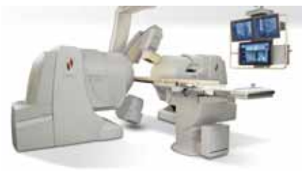
Obr. 8. Systém Niobe® Stereotaxis. Operační sál je kromě RTG zařízení vybaven dvěma stacionárními magnety, které mohou měnit svou pozici a rotovat, a vytvořit tak jakýkoli vektor výsledného magnetického pole potřebný pro navigaci ablačního katetru.
